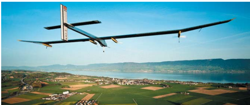
Solar Impulse – самолет, работающий исключительно на солнечной энергии
